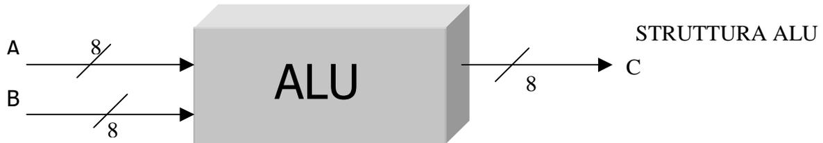
Sopra è illustrato uno schema generale dell' ALU, abbiamo preso due numeri ad 8bit (ingressi A e B) e abbiamo fatto il calcolo; ne è risultato un altro numero composto anch'esso di 8bit (uscita C).
